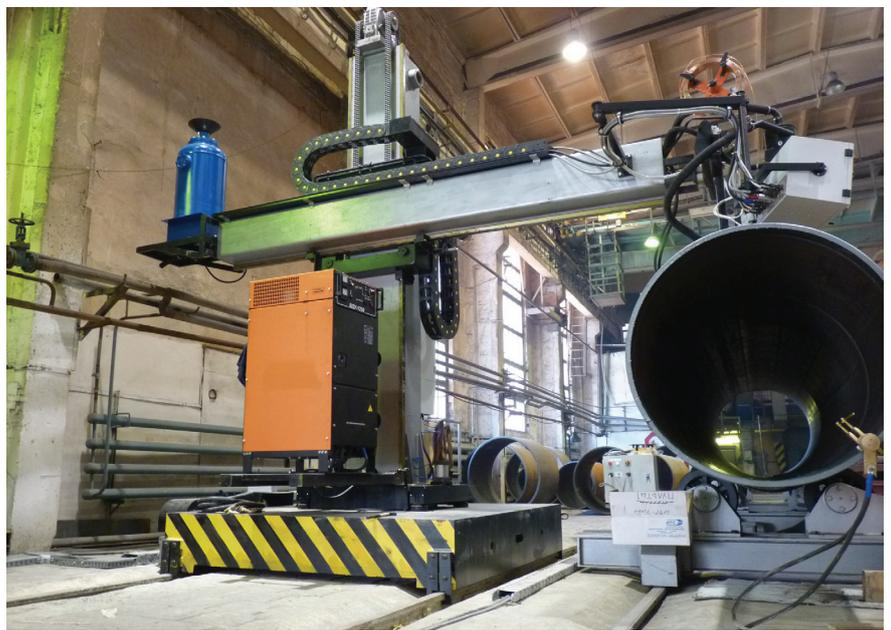
Колонна сварочная тяжелая серии КС-500 внешний вид
